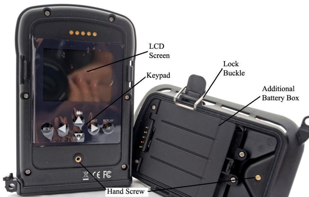
Slika 1.3: Pogled na stražnju stranu Ltl-5310M i prednju stranu kućišta za baterije
