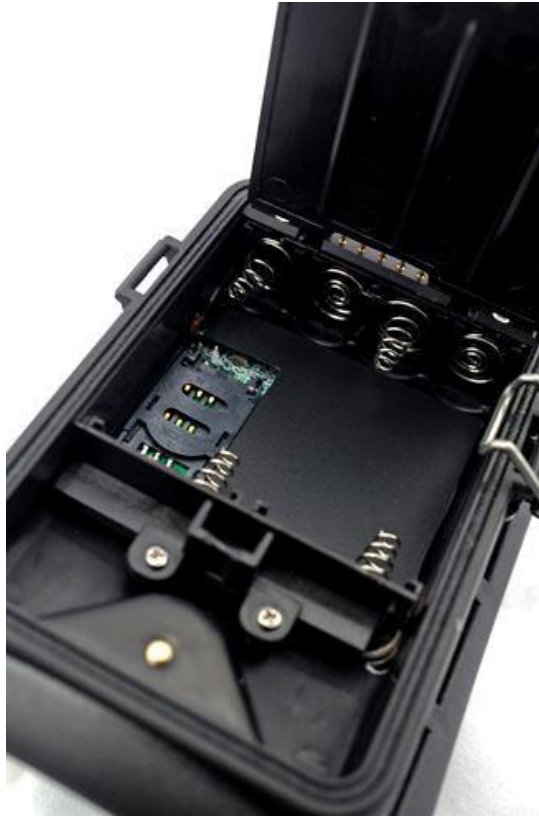
Slika 2-1 MMS-modul Battery Box
